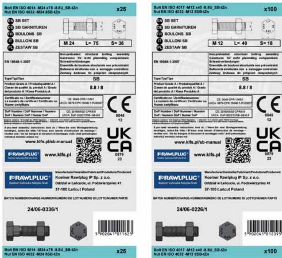
Rit. 20. Etiketter för SB-skruvsatser bestående av skruvar ISO 4014 eller ISO 4017 och muttrar ISO 4032
