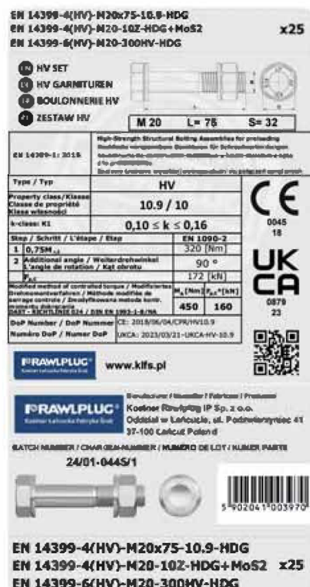
Rit. 11 Exempel på etikett med information om skruvsats i klass K1.
