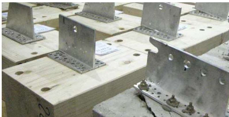
Test på provexemplar med reducerade dimensioner (trä-trä och trä-betong).
