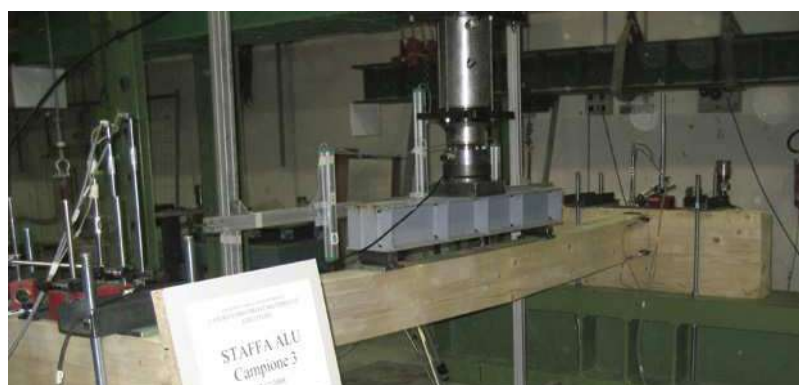
Test på fullskaliga provexemplar (anslutning primärbjälke/sekundärbjälke).
