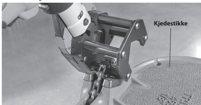
Figur 5 - Profilskjærehodet montert i kjedestikken
