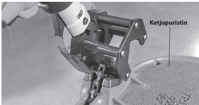
Kuva 5 – Ketjupuristimeen asennettu asennuskiskon leikkuupää
