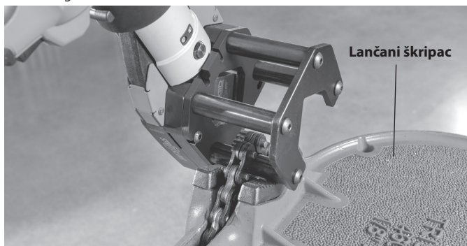
Slika 5 – Glava za rezanje nosača postavljena u lančani škripac
