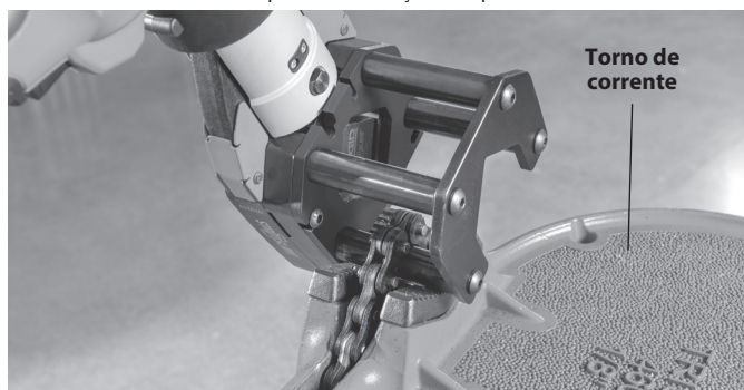
Figura 5 – Cabeça de cisalhamento de escora montada no torno de corrente
