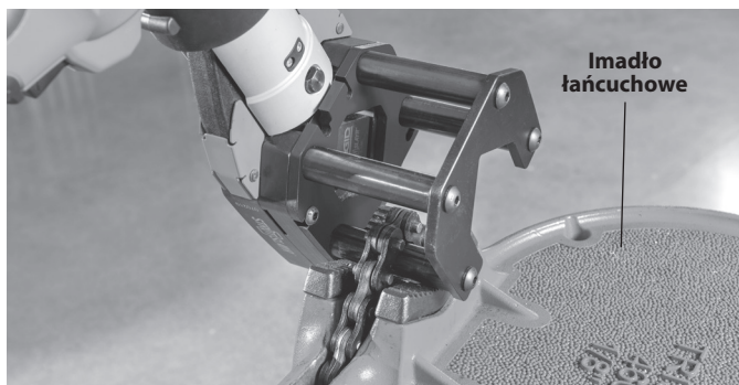
Rysunek 5 – Głowica nożycowa do szyn montażowych zamontowana w imadle łańcuchowym
