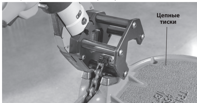
Рис. 5 - Режущая головка для стоечных профилей в цепных тисках
