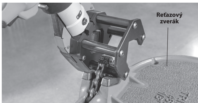
Obrázok 5 – Hlava na strihanie profilových tyčí namontovaná v reťazovom zveráku
