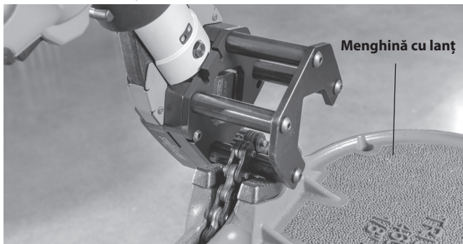
Figura 5 – Cap forfecare bare montat în menghină cu lanț
