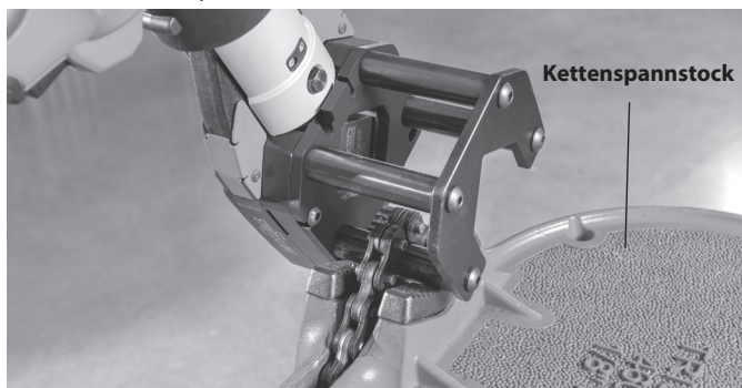
Abbildung 5 - Profilscherkopf, montiert im Kettenspannstock
