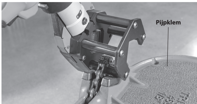
Figuur 5 – Balksnijkop gemonteerd in pijpklem
