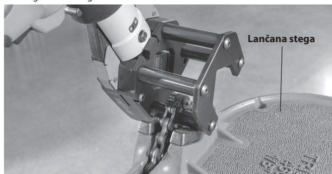
Slika 5 – Glava za sečenje podupirača postavljena u lančanu stegu
