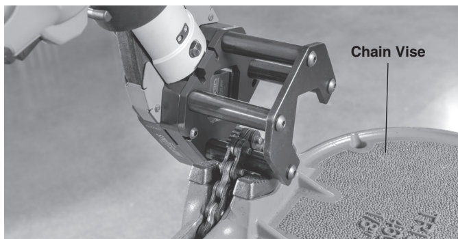
Figura 5 – Cabezal de corte de canaletas montado en una prensa de cadena
