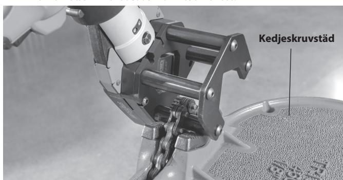
Bild 5 – Kaphuvud för stålprofiler monterat i kedjeskruvstäd
