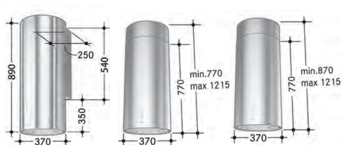
Tube fri- och vägghängd, se sida 35 (Frihängd med kolfilter)
