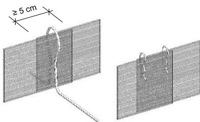
Fixera med montagebygel omega, alternativt med skarvclips CEMflex
