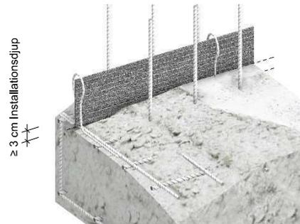
Installationsdjup minst 3 cm i gjutetapp 1
