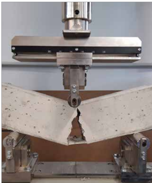
Bild tagen i laboratoriet som visar den spricköverbryggande kapaciteten hos Mapeproof FBT .
