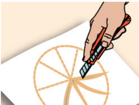
Figur 1 - Första biten av Mapeproof SA som ska skäras till för att passa diametern på elementet som passerar genom ytan
